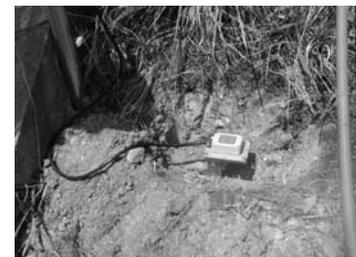
写真9 傾斜計取り付け
