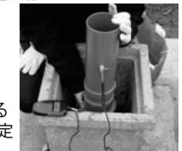
熱線風速計による
