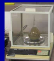
土粒子の密度試験の例
