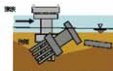
(a) 基礎の洗掘
