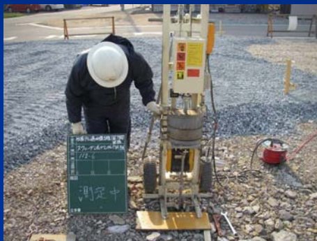
スウェーデン式サウンディング試験(自動式)
